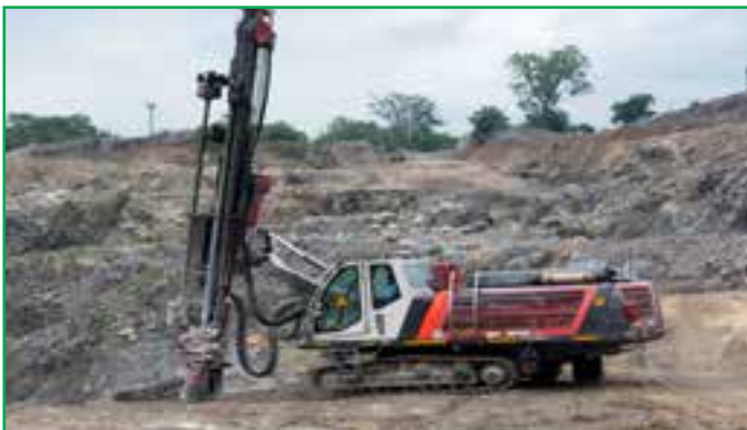
डोंगरी बुजुर्ग खान में आधुनिक पर्यावरण के अनुकूल हाइड्रो स्टैटिक ड्रिल मशीन
